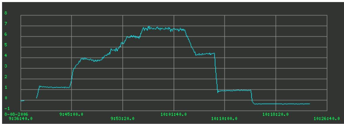
Рис. 3: Полный график пуска и останова компрессора.
