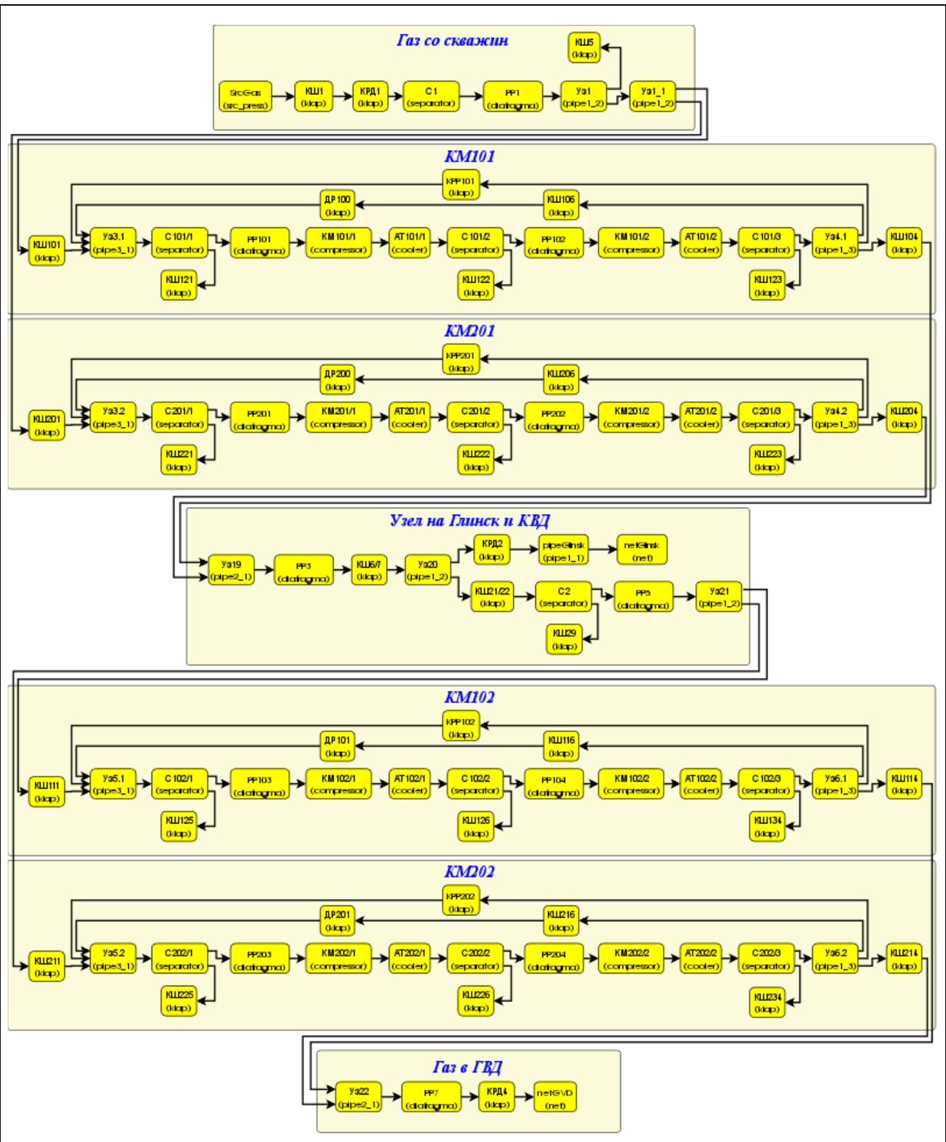
Рис. 2: Блочная схема модели ГЛКС.
