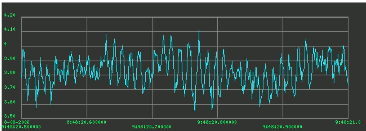
Рис. 5: График рабочего шума компрессора.
